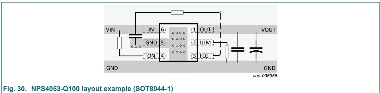
Fig. 30. NPS4053-Q100 layout example (SOT8044-1)
