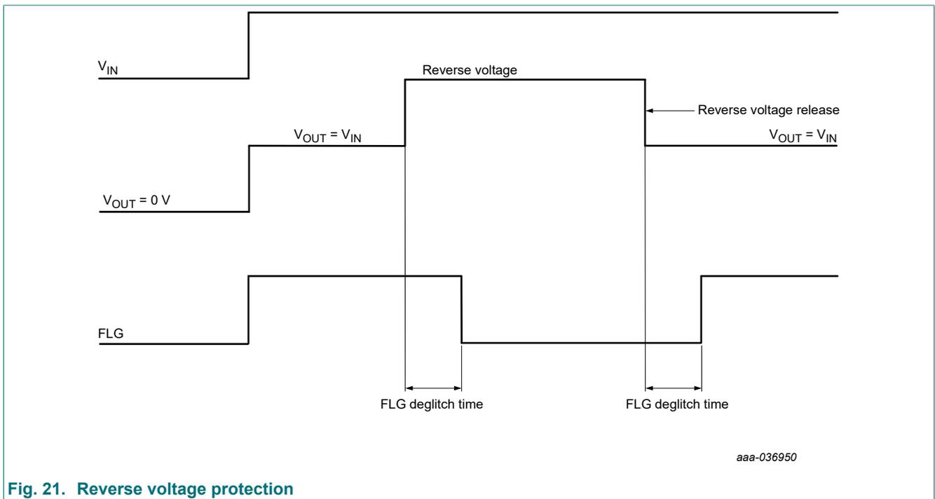
Fig. 21. Reverse voltage protection
