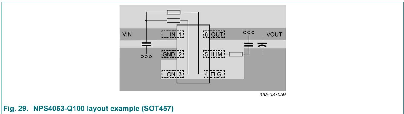
Fig. 29. NPS4053-Q100 layout example (SOT457)
