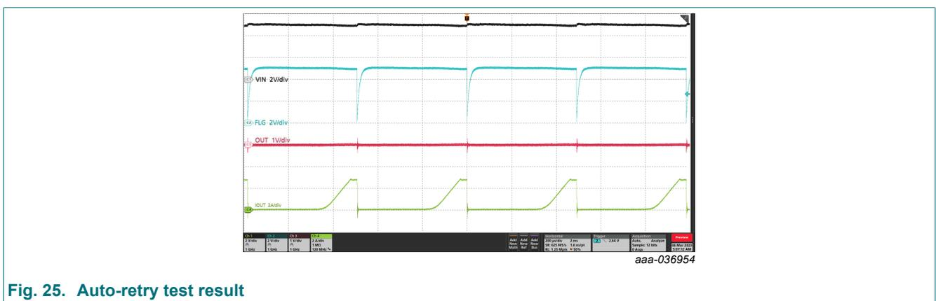
Fig. 25. Auto-retry test result
